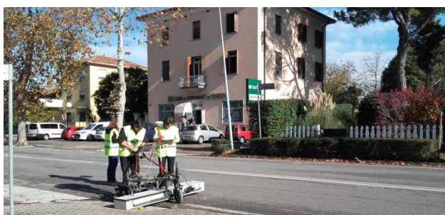
Scheda tipica monografia di rilievo e , a sinistra, mappatura con supporto georadar per ricerca reti non ispezionabili nel capoluogo
