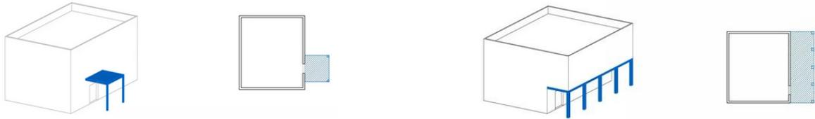
40. **Terrazza:** Elemento edilizio scoperto e praticabile, realizzato a copertura di parti dell'edificio, munito di ringhiera o parapetto, direttamente accessibile da uno o più locali interni.
