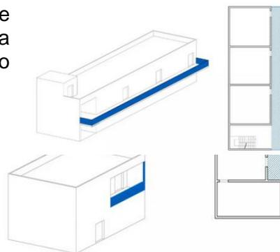
38. *Pensilina*: Elemento edilizio di copertura posto in aggetto alle pareti perimetrali esterne di un edificio e priva di montanti verticali di sostegno.
