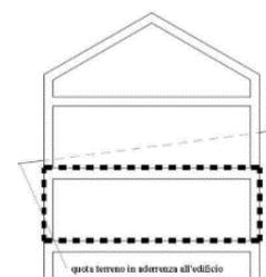
23. *Sottotetto:* Spazio compreso tra l'intradosso della copertura dell'edificio e l'estradosso del solaio del piano sottostante.
