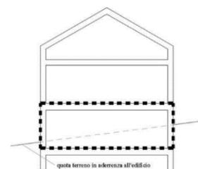
22. *Piano interrato:* Piano di un edificio il cui soffitto si trova ad una quota inferiore rispetto a quella del terreno posto in aderenza all'edificio.
