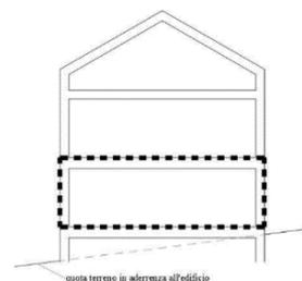
21. *Piano seminterrato:* Piano di un edificio il cui pavimento si trova a una quota inferiore (anche solo in parte) a quella del terreno posto in aderenza all'edificio e il cui soffitto si trova ad una quota superiore rispetto al terreno posto in aderenza all'edificio.
